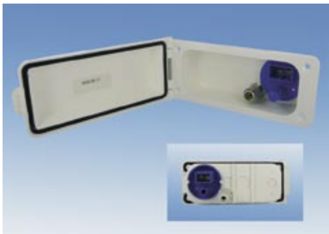
3500.06.19 Versorgungsklappe Wassereinspeisung Caravan-Versorgungsklappe für den Anschluss einer Tauchpumpe zur Wasserversorgung aus einem externen Kanister WASSER: Steckkupplung mit Stecker für Schlauch Ø 8 mm ELEKTRO: Steckdose zur Stromversorgung der Tauchpumpe
