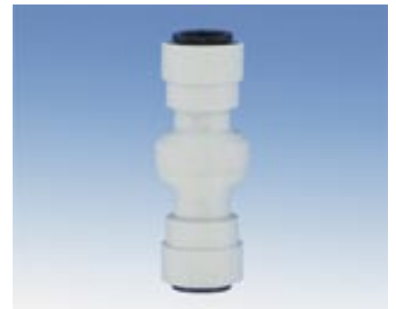
3004.02.12 JG-Cartridge 12 mm Rückschlagventil ohne Entlüftung für Außenpumpen Anschluss: PE-Rohr Außen-Ø 12 mm Ø / Höhe: max. 27 / 60 mm
