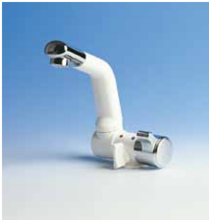
2410.43.21 2411.43.21 (mit Schalter) Mischer PRESTIGE mit Auslauf weiß / chrom Anschluss: Tülle Ø 10 mm Montagebohrung: Ø 27 mm Gewindelänge: 33 mm Gewinde-Ø: 3/4"
