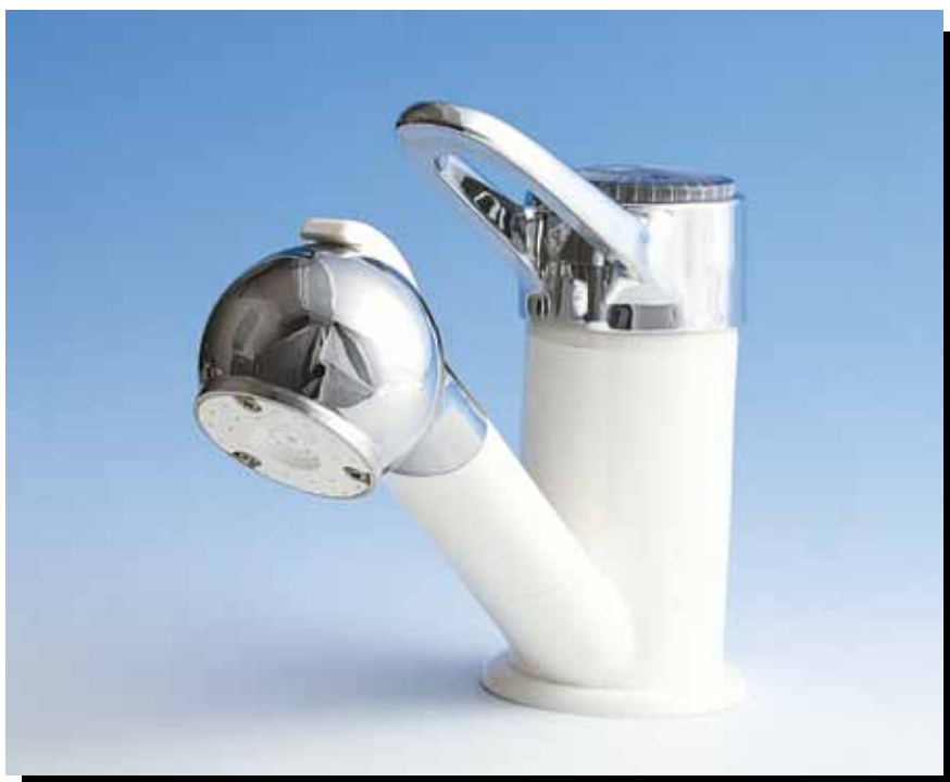
2558.43.69 2559.43.69 (mit Schalter) Einhebelmischer PRESTIGE mit ausziehbarer Dusche weiß / chrom Anschluss: Metallflexschläuche 3/8" Montagebohrung: Ø 40 mm Befestigungsset
