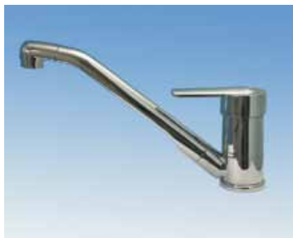
2802.20.21 2803.20.21 (mit Schalter) Einhebelmischer PARMA mit Auslauf 22 cm chrom Anschluss: Nylonflexschläuche Ø 10 mm Montagebohrung: Ø 33 mm Höhe: 170 mm Gewindelänge: 30 mm Gewinde-Ø: 1"
