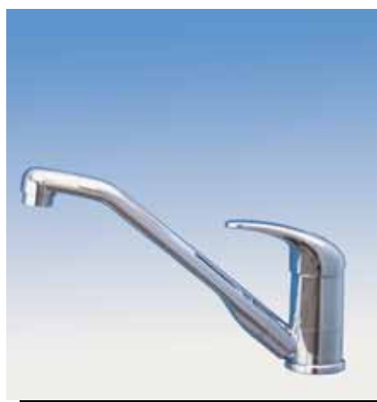
2770.20.21 2771.20.21 (mit Schalter) Einhebelmischer ROMA mit Auslauf 22 cm Kunststoff chrom Anschluss: Nylonflexschläuche Ø 10 mm Montagebohrung: Ø 33 mm Höhe: 170 mm Gewindelänge: 30 mm Gewinde-Ø: 1"
