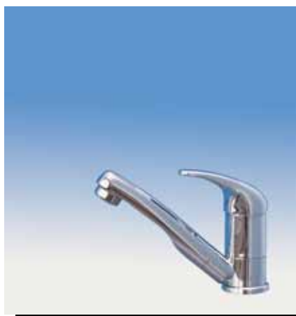
2758.20.21 2759.20.21 (mit Schalter) Einhebelmischer ROMA mit Auslauf 40° chrom Anschluss: Nylonflexschläuche Ø 10 mm Montagebohrung: Ø 33 mm Höhe: 150 mm Gewindelänge: 30 mm Gewinde-Ø: 1"
