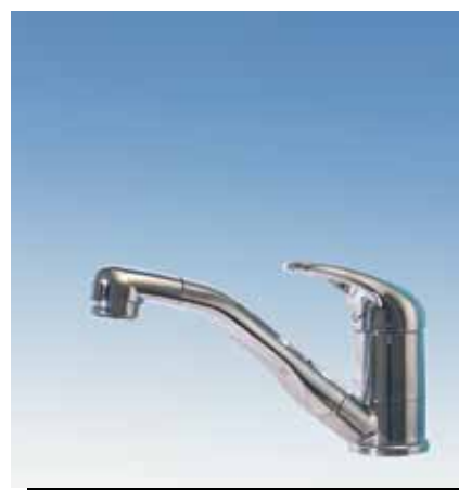
2772.20.21 2773.20.21 (mit Schalter) Einhebelmischer ROMA mit Auslauf 17 cm Kunststoff chrom Anschluss: Nylonflexschläuche Ø 10 mm Montagebohrung: Ø 33 mm Höhe: 150 mm Gewindelänge: 30 mm Gewinde-Ø: 1"
