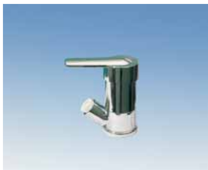
2804.20.21 2805.20.21 (mit Schalter) Einhebelmischer PARMA mit Duscheanschluss 1/2" chrom Anschluss: Nylonflexschläuche Ø 10 mm Montagebohrung: Ø 33 mm Höhe: 130 mm Gewindelänge: 30 mm Gewinde-Ø: 1"
