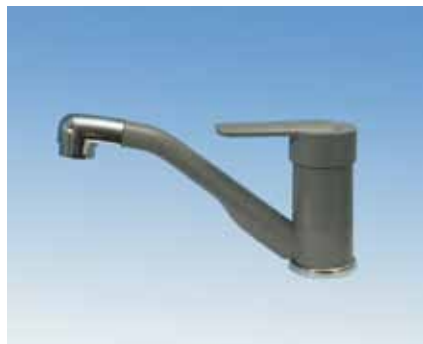
2800.74.21 2801.74.21 (mit Schalter) Einhebelmischer PARMA mit Auslauf 17 cm graumetallic / chrom Anschluss: Nylonflexschläuche Ø 10 mm Montagebohrung: Ø 33 mm Höhe: 130 mm Gewindelänge: 30 mm Gewinde-Ø: 1"
