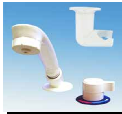
3208.73.02 Duscheset bestehend aus: Untertisch-Mischer LONDON (mit Schalter), Dusche NOVO, PVC- Schlauch weiß, Tischrosette und Dusche-Deckenhalter weiß Montagebohrung Armatur: Ø 22 mm Montagebohrung Rosette: Ø 33 mm
