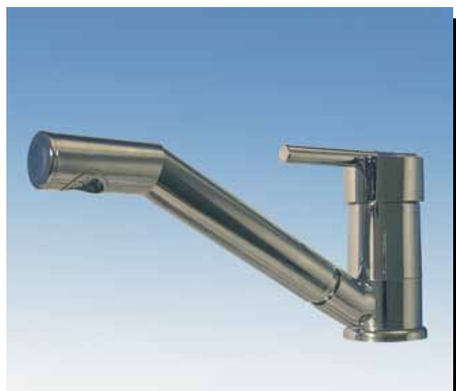
2862.20.21 2863.20.21 (mit Schalter) Einhebelmischer SIENNA mit ausziehbarem Auslauf SIENNA chrom Anschluss: Stangen Ø 10 mm außen Montagebohrung: Ø 33 mm Höhe: 130 mm Befestigungsset
