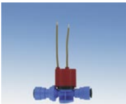
3002.13.32 Membranschalter 1,4 bar inline JG 12 mm für Bi- und FOR-Comet Installation im Schlauchsystem Anschluss: PE-Rohr Außen-Ø 12 mm Abschaltdruck: 1,4 bar
