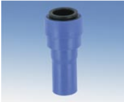
9140.01.12 JG-Cartridge 12 mm Entlüftung für Tauchpumpen aufsteckbar auf Druckseite der Pumpe, Zwangsentlüftung zur Ver- besserung des Ansaugverhaltens Anschluss: PE-Rohr Außen-Ø 12 mm Ø / Höhe: max. 23 mm / 49 mm
