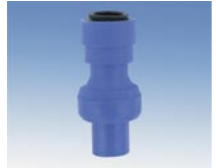
3006.01.12 JG-Cartridge 12 mm Wasserfilter für Außenpumpen Montage auf der Pumpensaugseite Anschluss: PE-Rohr Außen-Ø 12 mm Ø / Höhe: max. 27 mm / 60 mm
